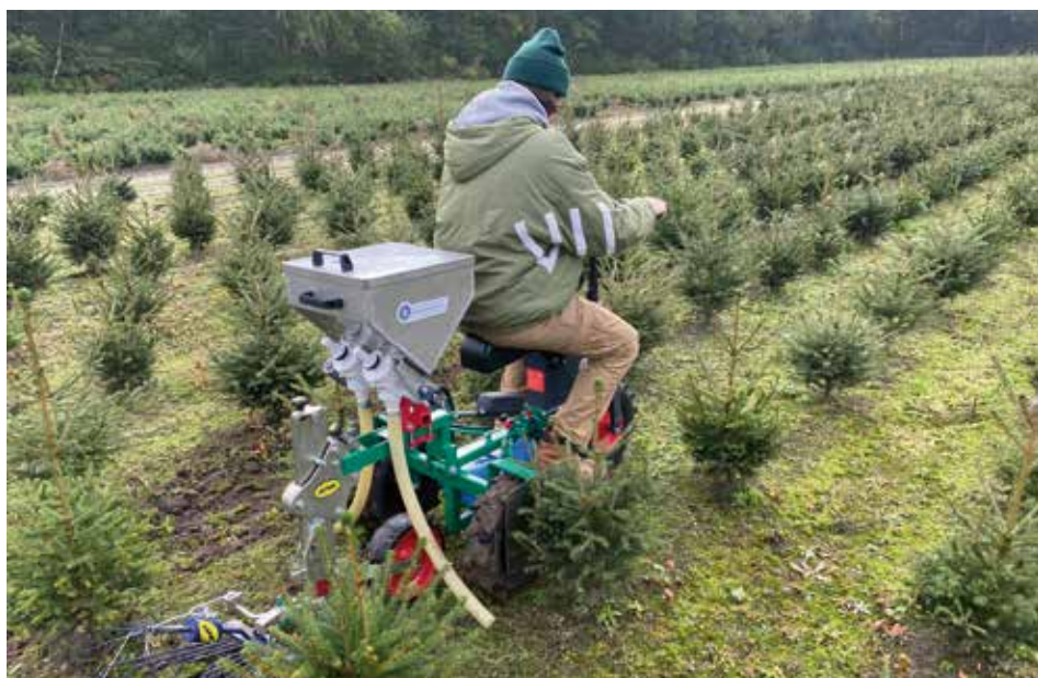
De Globus Compact E-Trike kan ook worden omgebouwd tot granulaatstrooier, zodat je rijenbemesting kunt toepassen.
