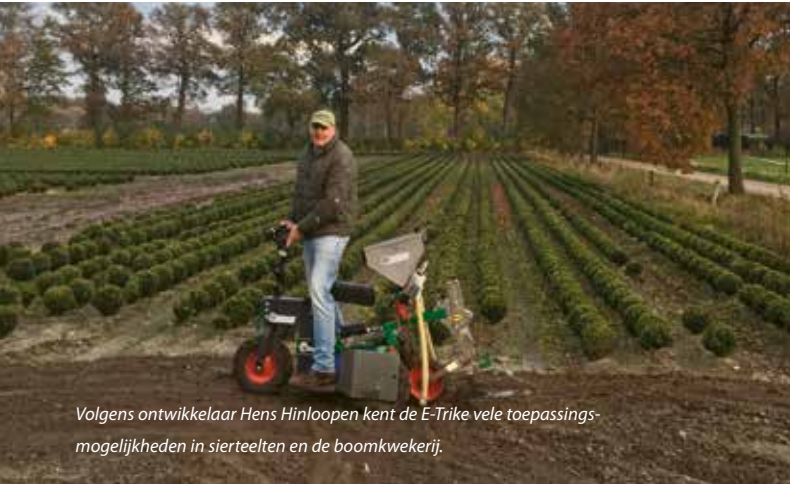
Torsiewieders/eggetanden aan weerszijden van de stevige ganzenvoetschoffel schrapen slepend het onkruid weg tot aan de tere stammen.
