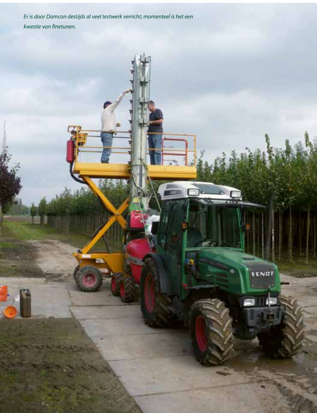
De mast is nu 5 meter hoog. Hoger dan 5 meter komt de stabiliteit in gevaar.
