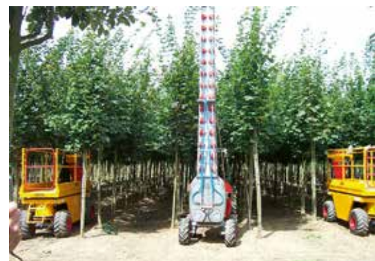
De mast is nu 5 meter hoog. Hoger dan 5 meter komt de stabiliteit in gevaar.
