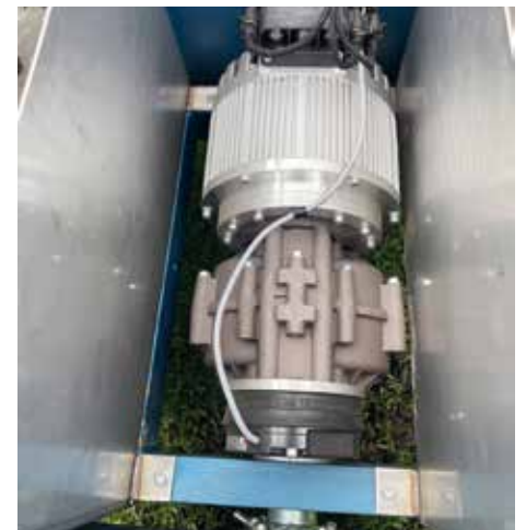
De A3000 is uitgevoerd met een onderhoudsvrije AC- elektromotor van 3.000 W.
