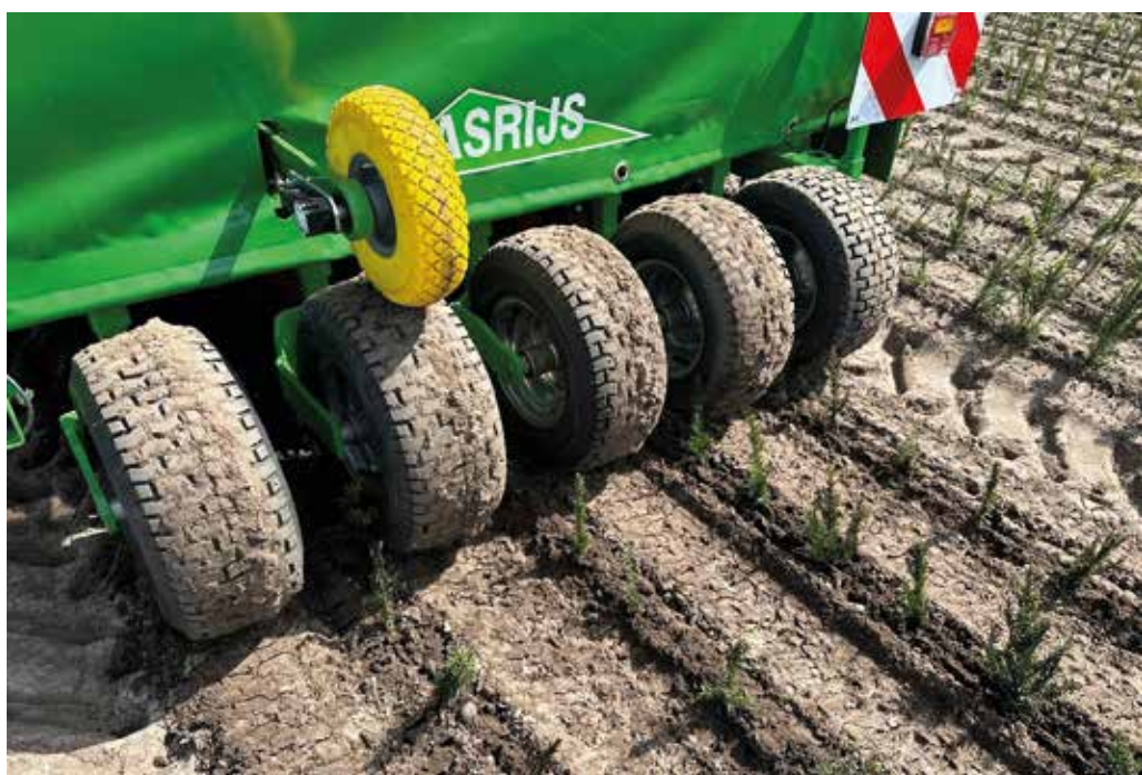
Plantresultaat van schijfplantmachine met elektrische plantafstandsregeling
